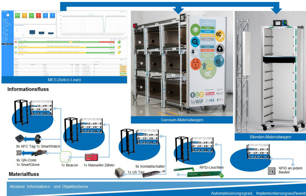
Bild 2. Konzept zur evolutionären Digitalisierung der Produktion durch Retrofitting von Materialwagen [11]
