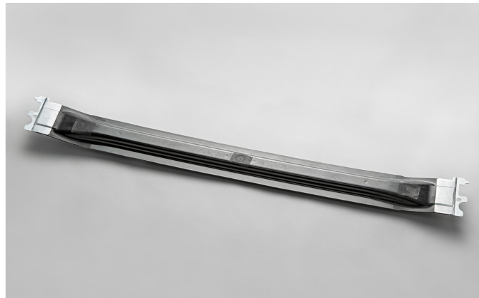
Bild 2. An einem herkömmlichen Dachspiegel wurden die Kohlenstofffasern mit duroplastischer Matrix durch ein Bauteil mit thermoplastischer Matrix substituiert
